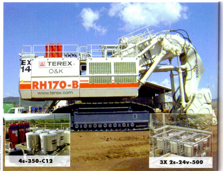
Referenzbeispiel: Arbeitsmaschinen mit Schlüsselfunktion mit 3x 24V KLEENOIL Nebenstrom-Feinstfilteranlagen und 1x KLEENOIL Nebenstrom-Feinstfiltereinheit für Filterung aller Hydraulik- und Getriebeöle.
