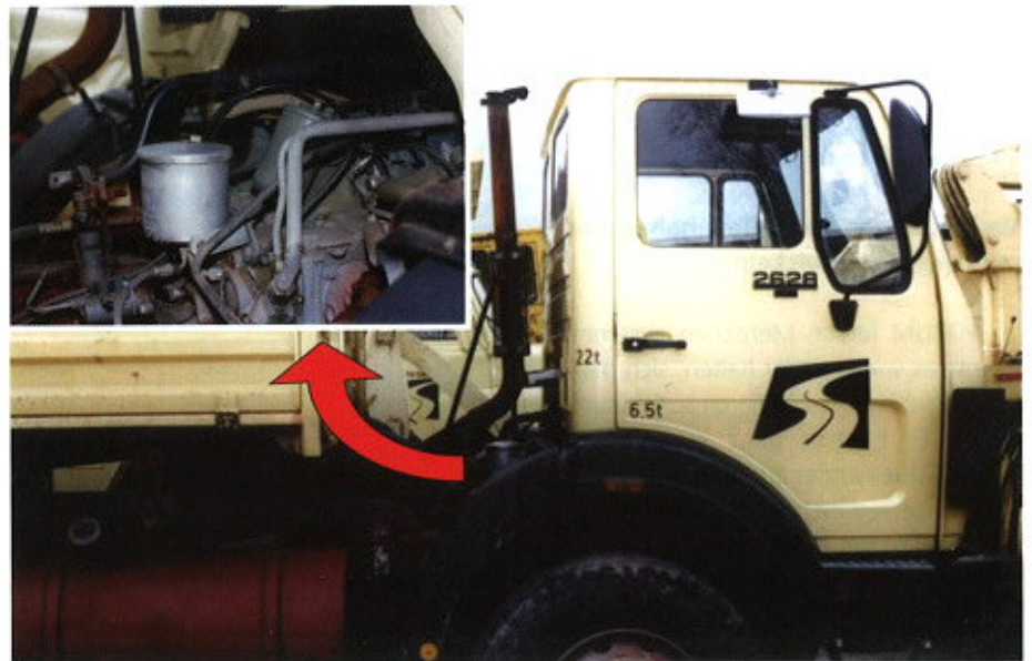
Ein Schleith-Lkw mit montiertem Nebenstromfilter aus dem Jahre 1988. (Fotos: Kleenoil Panolin)
