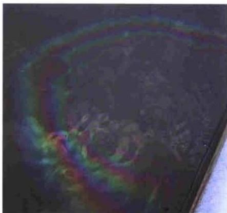
Mineralöl und Poly- \alpha -olefin bilden auf der Wasseroberfläche regenbogenfarbene Ringe.
