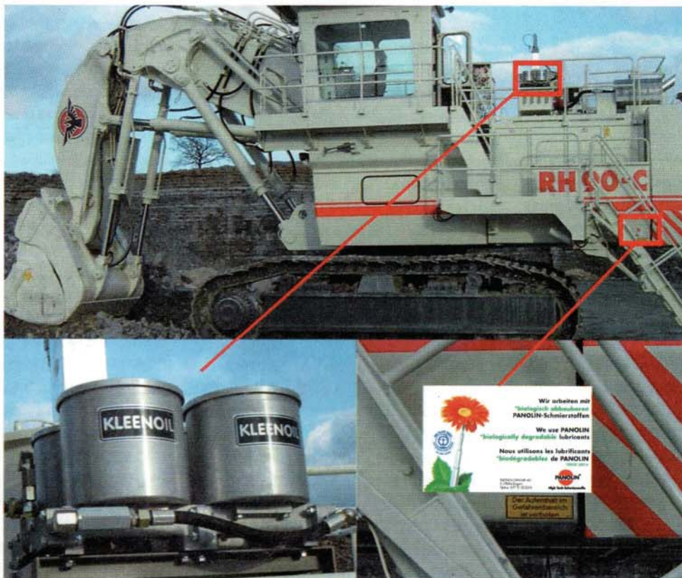
TEREX RH 90-C mit PANOLIN HLP SYNTH und KLEENOIL Nebenstromfilteranlage 4S-350-C12
