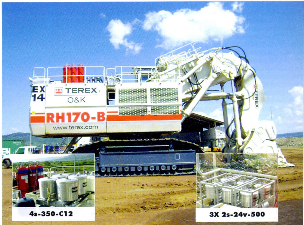
Arbeitsmaschinen mit Schlüsselfunktion mit 3x 24-V-KLEENOIL-Nebenstrom-Feinstfilteranlagen und 1x KLEENOIL-Nebenstrom-Feinstfiltereinheit für Filterung aller Hydraulik- und Getriebeöle.
