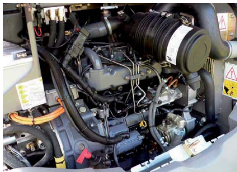
Zum Einsatz kommt ein Deutz Vierzylinder-Dieselmotor der Baureihe 2009 mit einer Leistung von 36,9 kW bei einer Drehzahl von max. 2100 min -1 .
