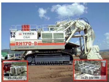
Referenzbeispiel: Arbeitsmaschinen mit Schlüsselfunktion mit 3x 24V Kleenoil Nebstrom-Feinstfilteranlagen und 1x Kleenoil Nebstrom-Feinstfiltereinheit für Filterung aller Hydraulik- und Getriebeöle.
