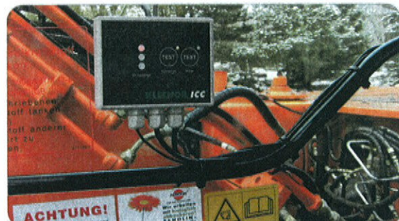
Die Ampel zeigt allgemein verständlich den Zustand des Öls an der 'ölwechselfreien Maschine' an.
