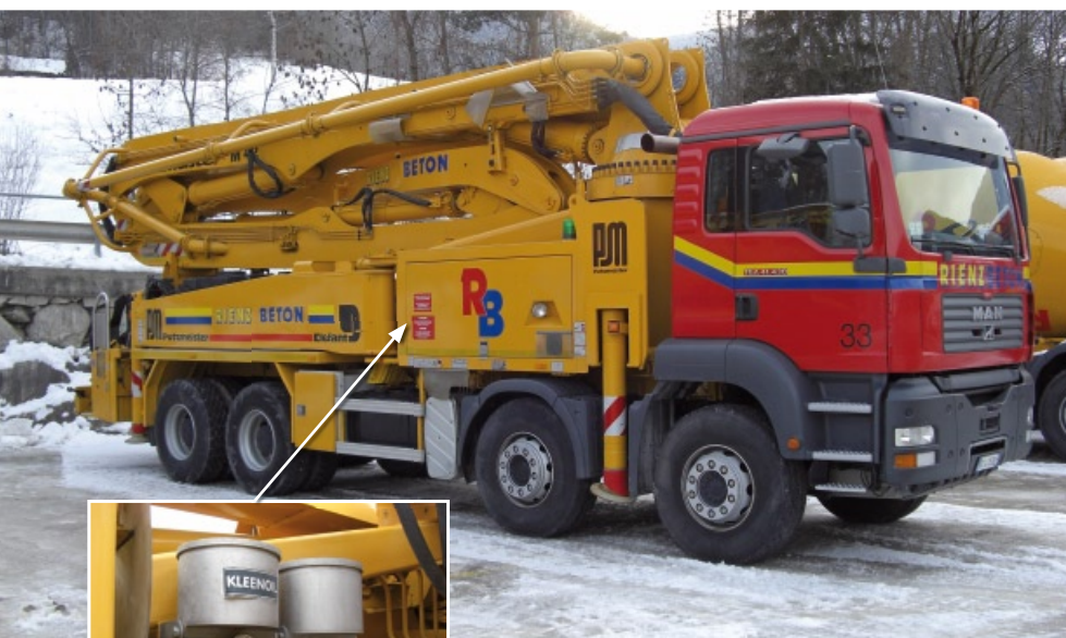
Seit 18 Jahren stattet die Firma Rienz Beton ihren gesamten Fuhrpark mit KLEENOIL Nebenstromfiltern aus (Motor, Hydraulik und teilweise Getriebe). Abgebildet: Putzmeister Beton Pumpe, 42 m
